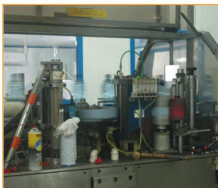
Avant l'étiquetage, les bouteilles d'eau sont pesées afin de vérifier le bon remplissage de la bouteille en eau... Si la machine estime que le niveau de remplissage n'est pas bon, la bouteille sera retirée de la ligne.
