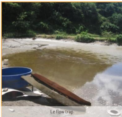
L'eau arrive par un tube dans un bac (le bac bleu sur la photo). La surverse du bac est évacuée par une rampe. Pendant ce temps, le niveau d'eau du bassin est progressivement abaissé (évacuation de l'eau du bassin vers la rivière du Carbet).
